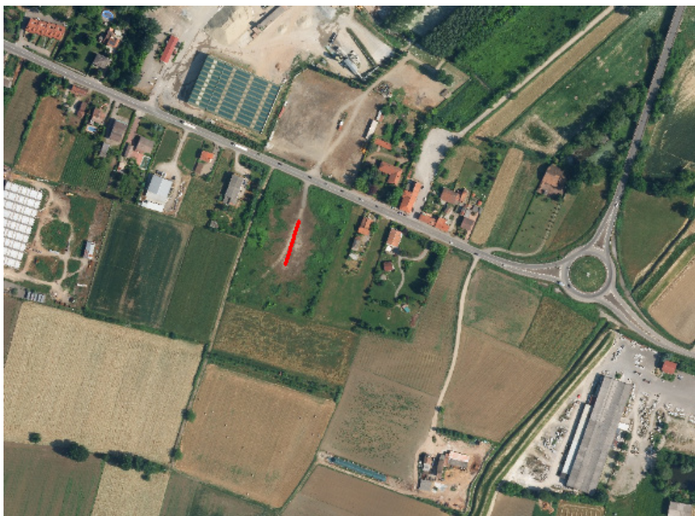
Arena Po 3: traccia stesa sismica M.A.S.W. (in rosso)
