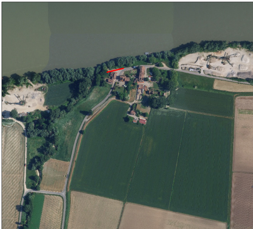
Arena Po 1: traccia stesa sismica M.A.S.W. (in rosso)
