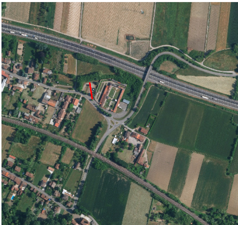
Arena Po 5: traccia stesa sismica M.A.S.W. (in rosso)
