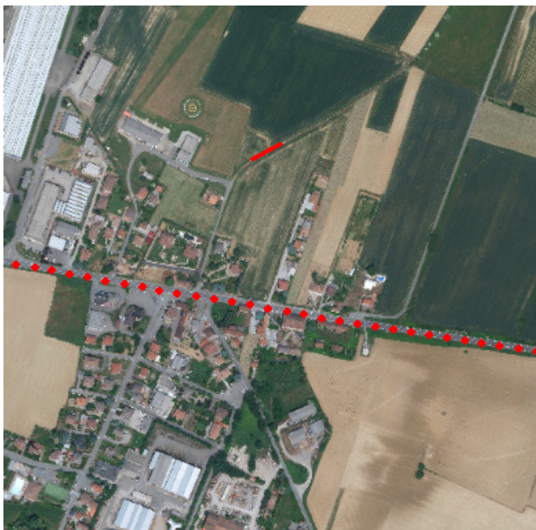
Arena Po 4: traccia stesa sismica M.A.S.W. (in rosso)
